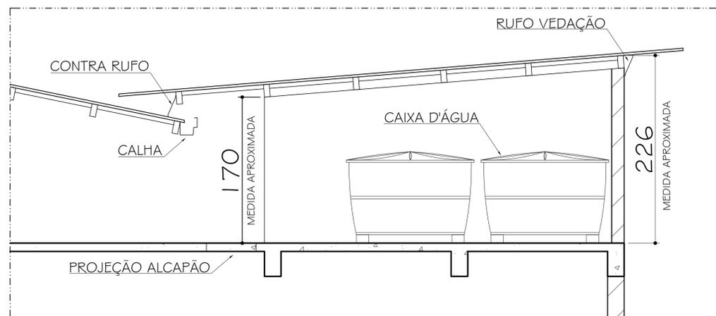
6 CORTE I-J - DETALHAMENTO TELHADO CAIXA DE ESCADA - ATUAL
