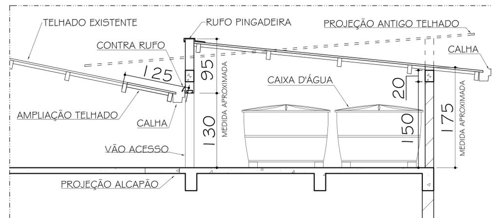
7 CORTE K-L - DETALHAMENTO TELHADO CAIXA DE ESCADA - À REFORMAR
