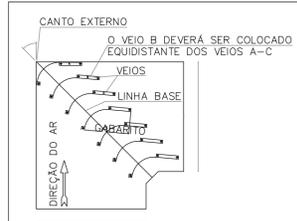
16 DETALHE PARA FABRICAÇÃO DE JOELHO
